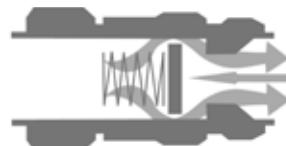
Обратный поток: опасная ситуация
