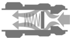
Normální tok – pojistka otevřena
