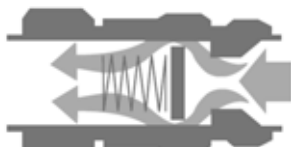
Нормальный поток: клапан открыт
