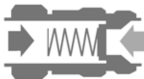
Rückströmung - Ventil schließt
