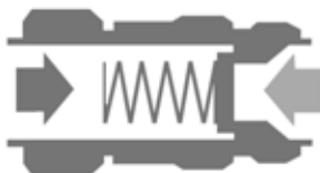
Обратный поток: клапан закрыт
