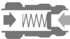
Zpětný tok – pojistka uzavřena
