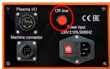
Na posição Off-line, os acionamentos de engrenagem não são alimentados com energia para que o sistema possa ser posicionado manualmente em qualquer um dos eixos. Na posição ON, os acionamentos são engrenados para operação normal.
