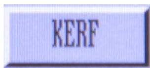
Esta función se utiliza para introducir un valor de compensación de la ranura de corte.
