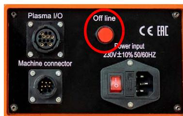
En la posición Off line, los accionamientos por engranaje no reciben alimentación eléctrica, de modo que puede posicionarse manualmente el sistema en ambos ejes. En la posición ON, los accionamientos se activan para el funcionamiento normal.
