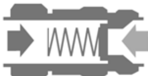
Обратный поток: клапан закрыт
