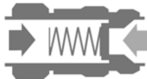
Rückströmung - Ventil schließt
