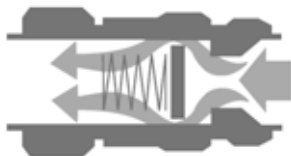
Normální tok - pojistka otevřena
